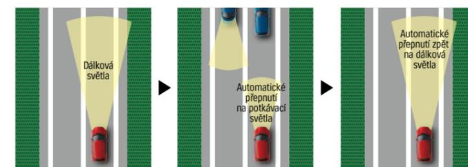
Pokud je to možné, dálková světla jsou zapnutá. Když systém zaznamená světla vozidla jedoucího vpředu nebo v protisměru, přepne na potkávací světla. Jakmile ostatní vozidla nejsou v dohledu, automaticky se znovu zapnou dálková světla.
