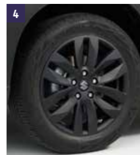
4 | Ráfek z lehké slitiny „MISTI“ 6,5 J × 17“ Pro 215/55 R17, včetně středové krytky s logem Suzuki, schválení podle norem ECE-R 124. Černá matná Objednací číslo 990E0-61M76-002 Černá lesklá Objednací číslo 990E0-61M78-002
