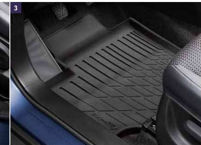
3 | Sada koberečků, pryžové 1,2 Zvýšený okraj napomáhá udržet čistotu v prostoru pro nohy. Vyrobeno z TPS, vyšší tuhost při nižších teplotách. Zdrsněný povrch zabraňuje uklouznutí. Sada čtyř kusů, pro manuální a automatickou převodovku. Objednací číslo 75901-57TB0-000 LEVOSTRANNÉ ŘÍZENÍ Objednací číslo 75901-57TA0-000 PRAVOSTRANNÉ ŘÍZENÍ (bez ilustrace)
